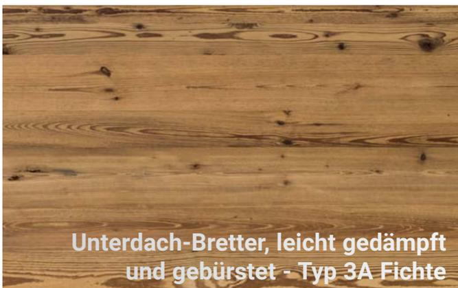
Unterdach-Bretter, leicht gedämpft und gebürstet - Typ 3A Fichte
