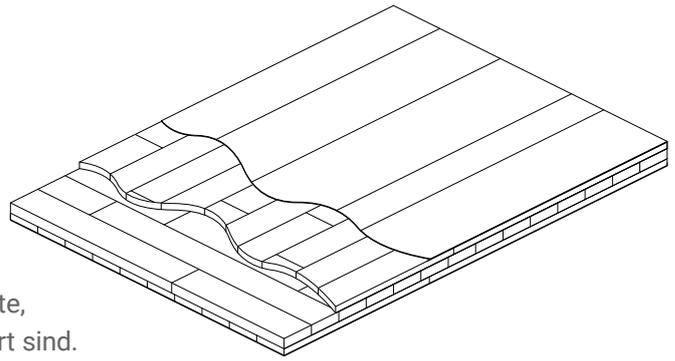
ECO TEC besteht aus einer bewährten ALFA-3-Schichtplatte, deren drei Lagen alle aus keilgezinkten Lamellen produziert sind. Die Decklagen sind mit Messerfurnieren in Längsrichtung kaschiert.
