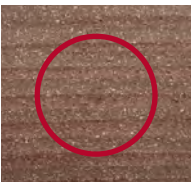
natürlicher Fasereinschluss nach mechanischer Behandlung
